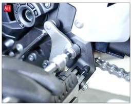
AG) Reinstall the chain sprocket cover.
